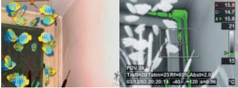
Imágen visual e infrarroja de un dormitorio. La imagen infrarroja nos muestra claramente las zonas delicadas en donde el moho puede crearse.
