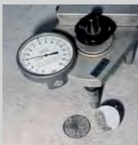
Determinación de la cohesión
