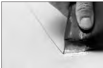
Ensayo de la soldadura en sentido longitudinal
