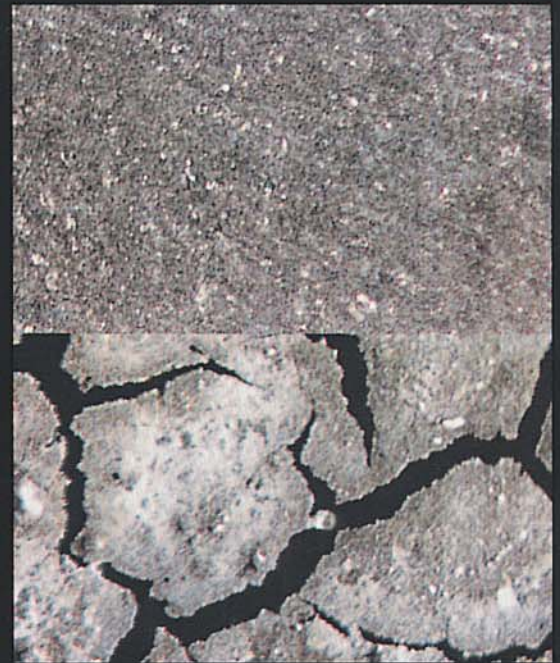
Comparación entre el Sikaflex®-265 resistente a la radiación-UV con un producto competidor que ha fallado después de algunos años de exposición a esta radiación (aumentada 150 veces).
