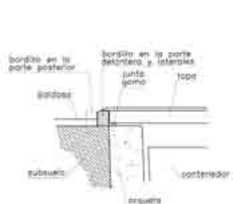
DETALLE A Colocación de la tapa
