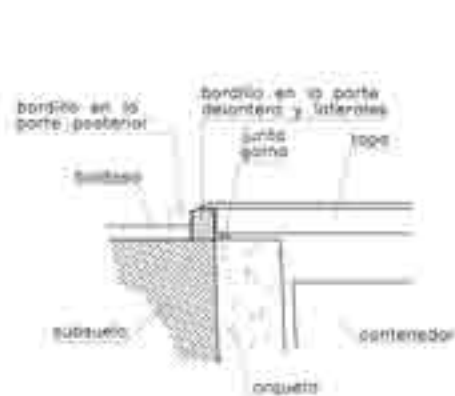
DETALLE A Colocación de la tapa
