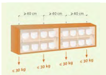
Figura 2: Reparto de la carga.
