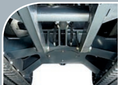
El nuevo tren de rodaje con bastidor X-Frame ofrece una mayor distancia del suelo y una fácil limpieza.
