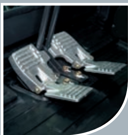
Los nuevos y ergonómicos pedales de fundición de aluminio aseguran un control del desplazamiento de la máquina suave y fiable.
