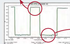
Corriente del Neutro SIN Filtro Activo
