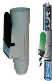
Esquema de funcionamiento del filtro Rainus
