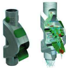
Esquema de funcionamiento del filtro Rainus
