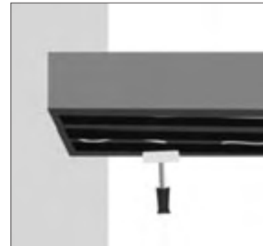
4. Colocar el CARBOPLATE ejerciendo una presión uniforme con un rodillo duro.
