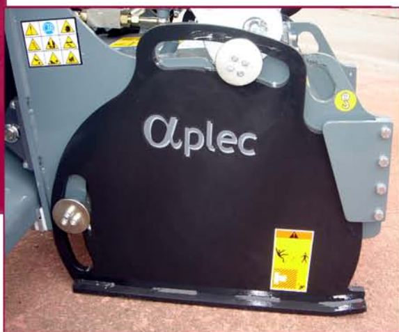
▲ Patín con autonivelación independiente Self levelling of both slides
