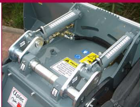
▲ Control de profundidad mecánico (hidráulico opcional) Mechanical depth control (hydraulic optional)
