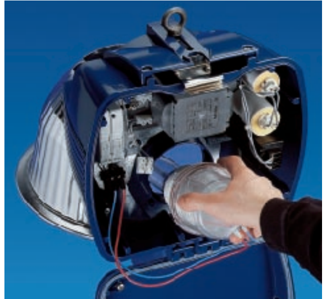
Acceso a la lámpara por rotación de un cuarto de vuelta del obturador portalámpara. La placa de auxiliares eléctricos es desmontable tras aflojar tres tornillos de fijación.
