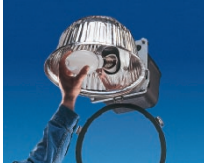
Se accede a la lámpara desbloqueando tres clips de acero inoxidable. El protector permanece sujeto durante el mantenimiento. Se observa la posición superpuesta de los auxiliares eléctricos y de la lámpara, lo que permite una evacuación óptima del color.
