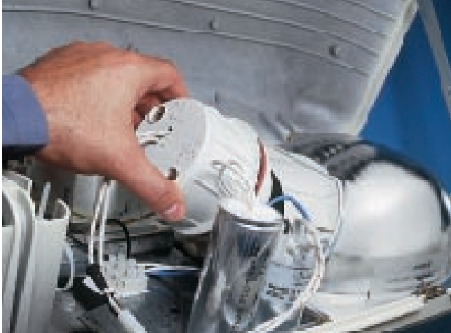
Se accede a la lámpara mediante rotación del soporte portalámparas en un cuarto de giro.
