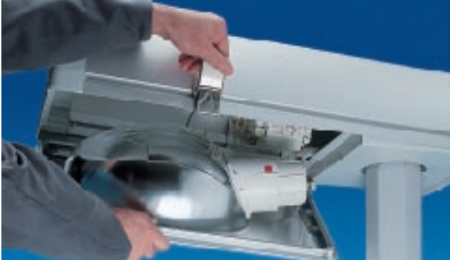
Después de desbloquear un clip de acero inoxidable, el bloque óptico gira alrededor de una bisagra.
