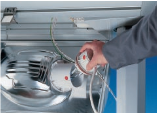
El cambio de lámpara se efectúa mediante rotación de un cuarto de giro del obturador.
