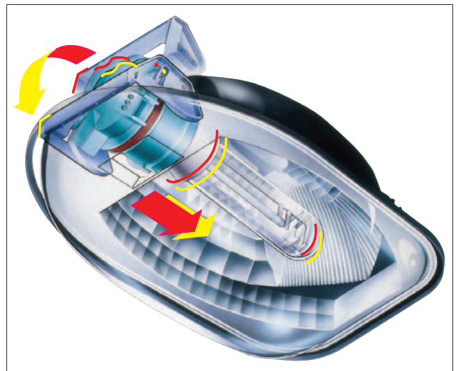
Sistema Easilok®: Bajando la palanca de bloqueo, el obturador queda automáticamente colocado e inmovilizado: garantía de una perfecta hermeticidad del bloque óptico (IP 66). Desconexión eléctrica automáticamente en el momento en que se extrae el obturador.
