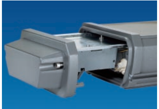
Se accede a la lámpara y a la placa de auxiliares eléctricos aflojando dos tornillos del conjunto que se encuentra en uno de los extremos del proyector.
