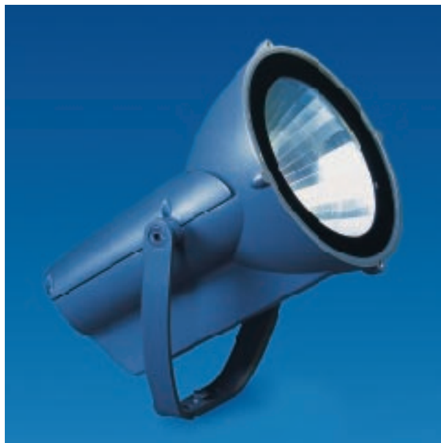
Focal: proyector compacto para lámparas de hasta 150 W con una amplia gama de distribuciones fotométricas (Intensidad en punto: de 32.000 a 300 cd/klm).
