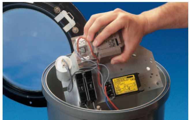
Se accede a la lámpara y a los auxiliares eléctricos – montados en placa desmontable – mediante 4 cierres rápidos.
