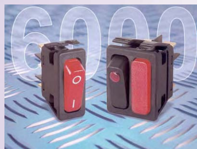
Serie 6000: 11x30 y 22x30mm, sp, dp, ilum., IP67: 16(4)A-250Vac, inrush 150A
