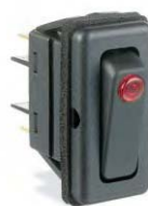
Serie 6100 IP67: Interruptor basculante luminoso 11x30 y 22 x30 con estanqueidad interna
