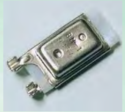
Tipo BM-1 metálico 75-170°C, 230Vac-8A, bimetalo alta/baja resistividad
