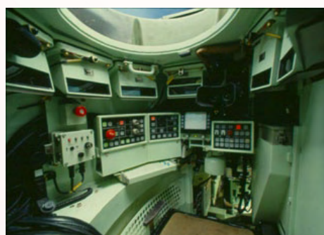
Teclados específicos, interruptores 12000 & capuchones de seguridad. Tableros de mando de carros de combate
