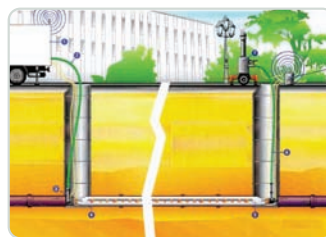
Reversión de tubería (fase vapor sin presión)
