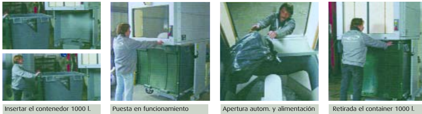
Insertar el contenedor 1000 l. Puesta en funcionamiento Apertura autom. y alimentación Retirada el container 1000 l.
