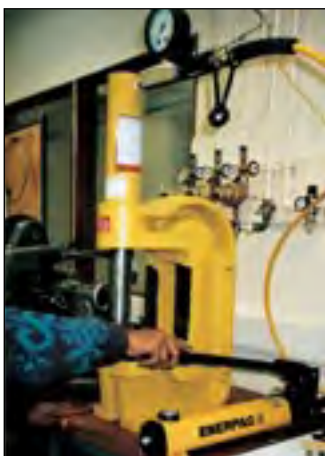
◀ A-310 Prensa de mandrinar, utilizada para compactar la potencia a 10 toneladas.
