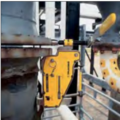
▼ Enerpac ATM-3 aplicado para alinear una brida de mayores dimensiones ANSI.
