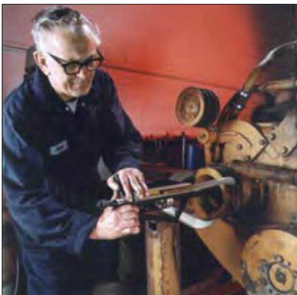
◀ Colocación de un extractor de 3 garras EP-104 en la transmisión de un motor diesel.
