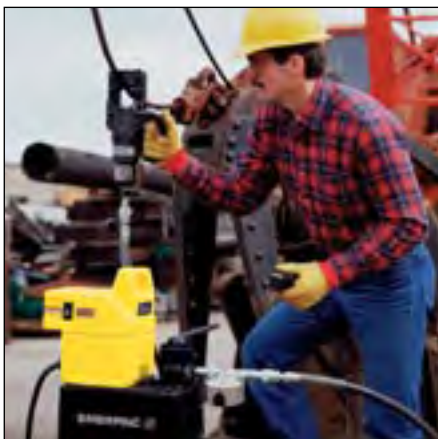
◀ Una bomba Titan PUJ-3309E accionando un cortador hidráulico para cable.
