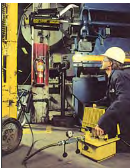
◀ Los extractores hidráulicos EPHR-116, de 50 toneladas Posi Lock® quita fácilmente el engranaje principal de esta prensa de trabajo por deformación.
