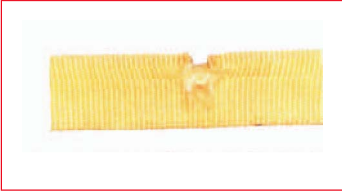
Corte causado por bordes agudos en los orillos
