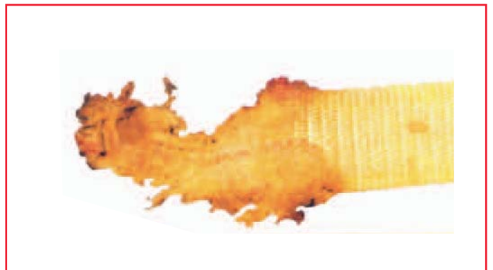
Daños causados por ácidos
