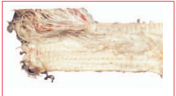
Daños causados por sobrecarga
