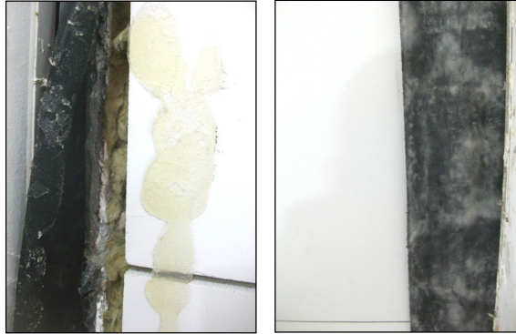
Imágenes 30 y 31 Lana de roca y butilo entre Paneles \Omega Z y marco portamuestras
