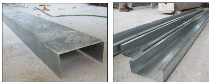
Imágenes 1 y 2 Perfiles y montantes de acero
