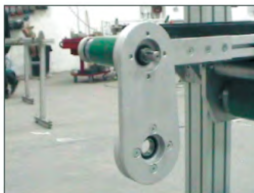
Motorizzazione diretta con rulli Ø50 lato motore Trasmitted motorization with rollers Ø50 motor side
