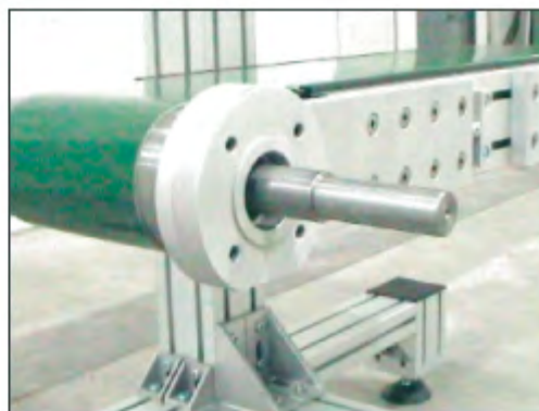
Motorizzazione diretta con rulli Ø95 lato motore Direct motorization with rollers Ø95 motor side
