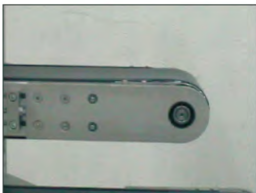
Motorizzazione diretta con rulli Ø95 lato rinvio Direct motorization with rollers Ø95 transmitted side
