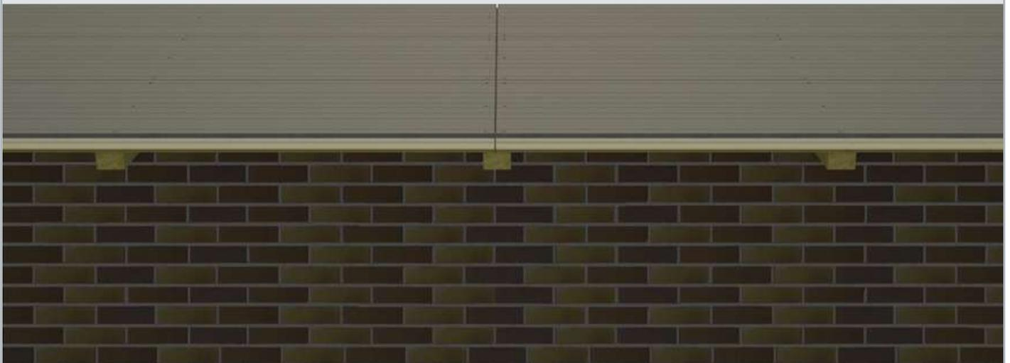
En el alero se fijará el remate de madera ONDUTHERM a la estructura, impermeabilizando el encuentro con masilla ONDUFLEX para evitar filtraciones.
