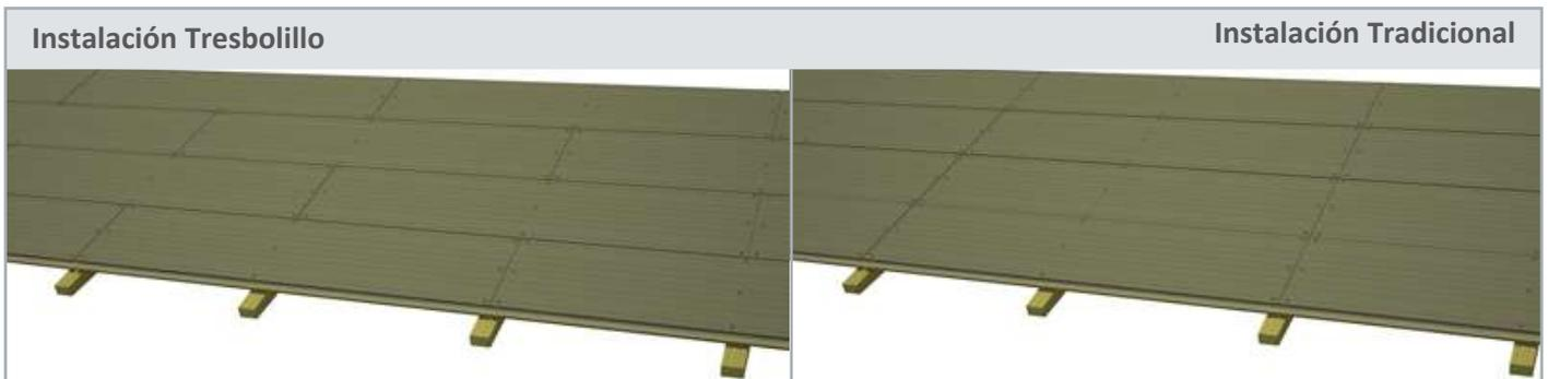
En estructura metálica, el espesor del tablero aglomerado hidrófugo superior debe ser de 19 mm debido a la presión que ejerce la fijación autotaladrante.
