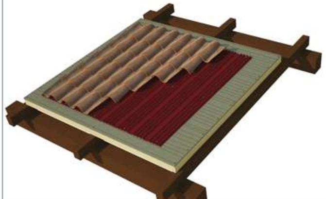
El sistema Onduline® Bajo Teja se fija mecánicamente a los paneles sándwich ONDUTHERM asegurando una perfecta sujeción e impermeabilización.
