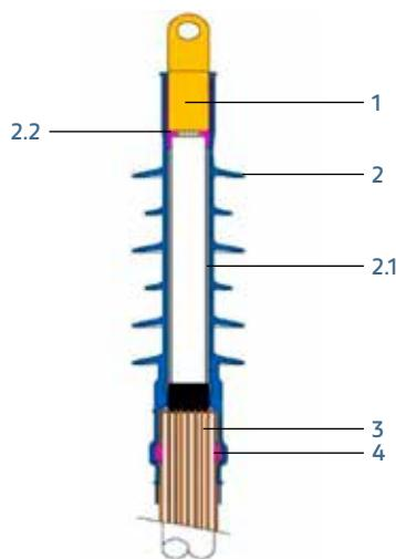
Contráctil en frío: No necesita herramientas especiales, mezclas de relleno o aplicación de la llama para su montaje. Se puede instalar en posición vertical o en ángulo (30°). Se puede energizar la línea inmediatamente después de la realización de la terminación.
