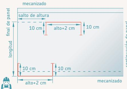
Procedemos a unir la intersección de las marcas de 10 cm entre ellas y con este último paso ya se ha dibujado la forma de la tapa del quiebro y se procede a cortarla con el cuchillo.
