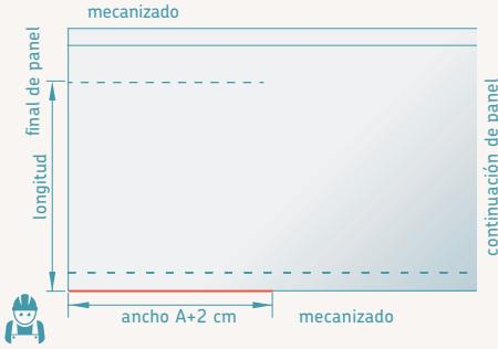
Se traza una recta paralela al final de panel. La distancia será ANCHO A (ancho interior de la sección de entrada) más 2 cm. Seguidamente se trazan dos líneas paralelas al mecanizado inferior del panel, a una distancia de 10 cm, que se cruce con la recta realizada anteriormente y con el final de panel.
