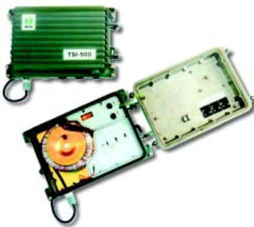
La unidad **TSI-500** es un «alimentador/inyector AC» configurable en RF como *inyector simple, distribuidor 2 salidas ó derivador 1 salida*. Permite inyectar una tensión 60 VAC en cualesquiera de los cables coaxiales de conexión (2 cables cuando se utilice como inyector simple ó 3 en las configuraciones distribuidor o derivador).
