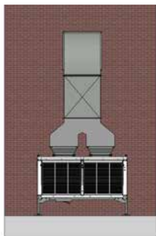
AD TWIN VS Salida superior con pantalón
